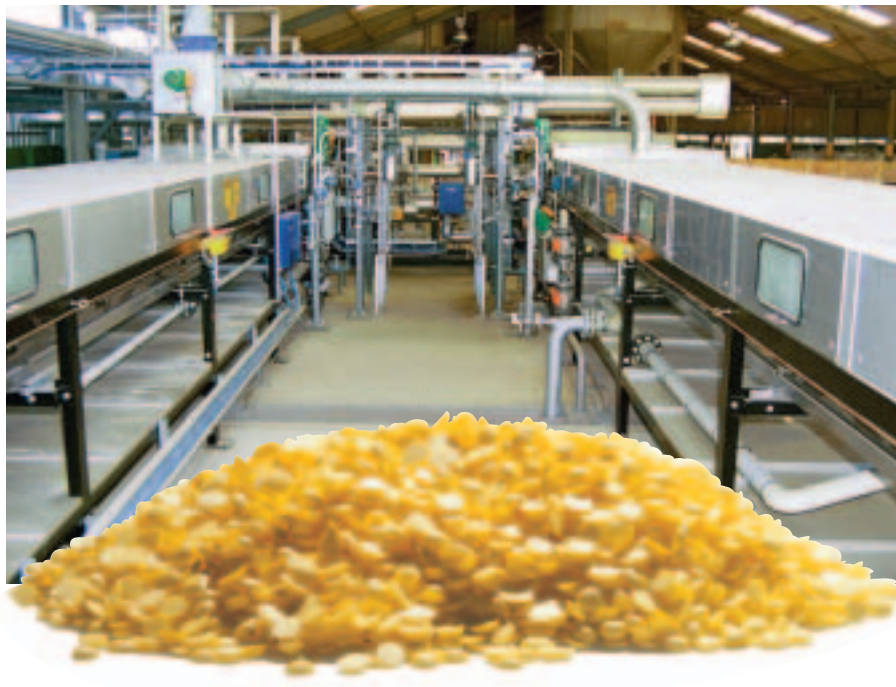
Линии гранулирования Sandvik со стороны подачи продукта
