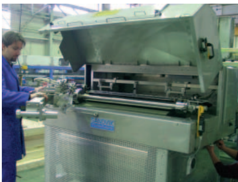
Ротоформер подготовленный для техобслуживания
