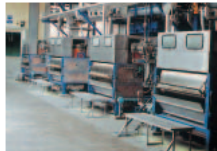
Линии гранулирования Sandvik со стороны подачи продукта
