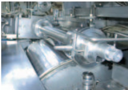
Ротоформер установленный на конвейере-охладителе
