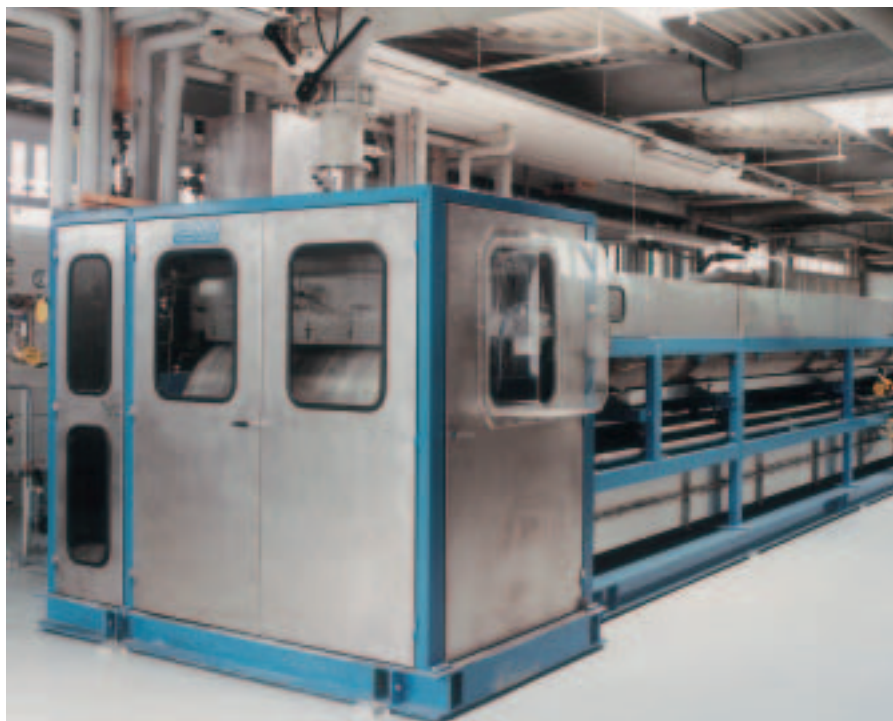
Линия с предварительным охлаждением для агрохимикатов
