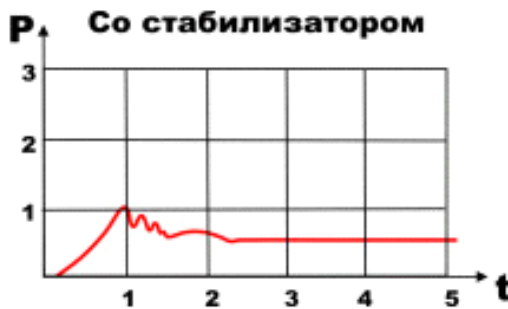
Рис.3. Типовые диаграммы, иллюстрирующие работу СД при гидроударе:
