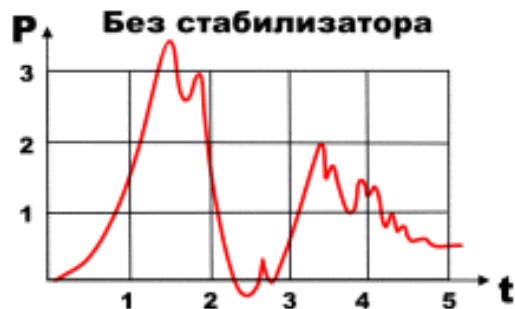
Рис.3. Типовые диаграммы, иллюстрирующие работу СД при гидроударе:
