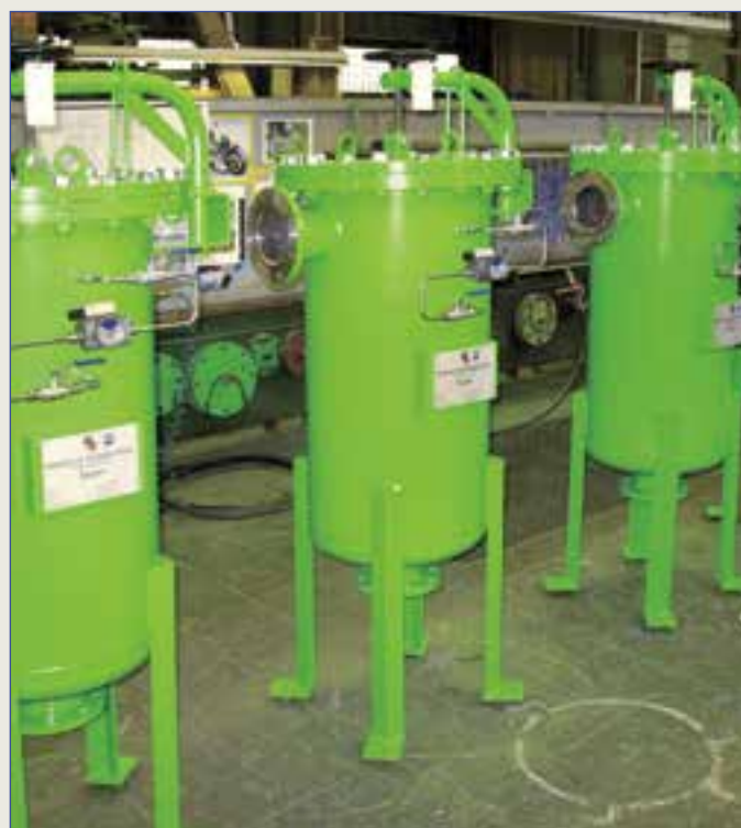
Рис. 5 Мешочный фильтр, корпус сварной.
