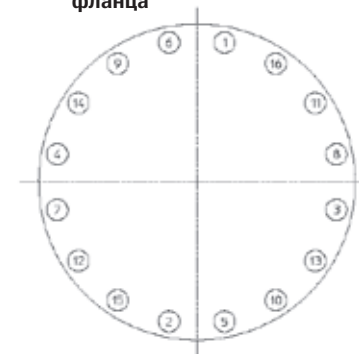
Рис. 3 - Затягивание болтов - последовательность затягивания фланца
