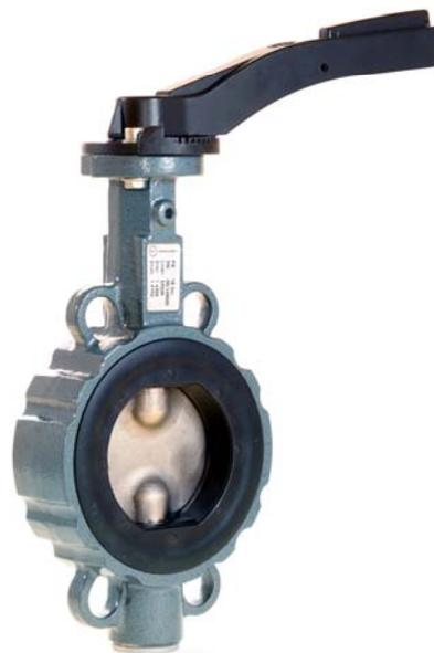
Затвор с промежуточным фланцем универсального применения. Разнообразие имеющихся в распоряжении базисных материалов корпуса, диска, уплотнения позволяет применять в различных областях. Съемная легкозаменяемая манжета из эластомера.
