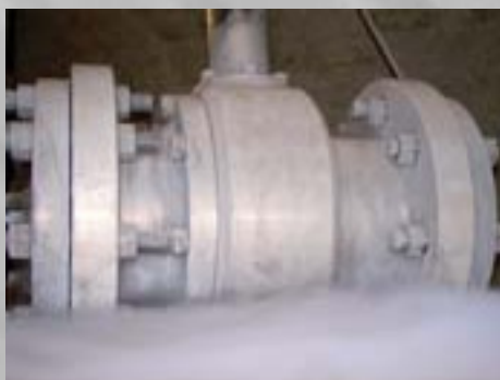
Знаменитый тест с тепловым ударом (Резкое изменение температуры от отрицательных до положительных значений)
